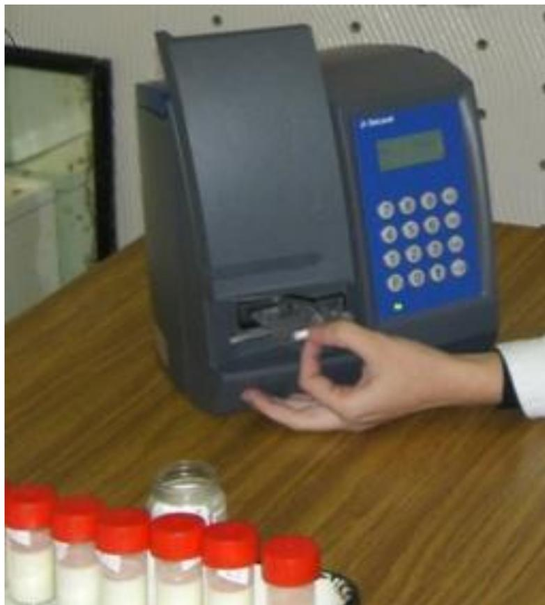
Рисунок 98 – Счетчик для прямого подсчета соматических клеток фирмы DeLaval.
